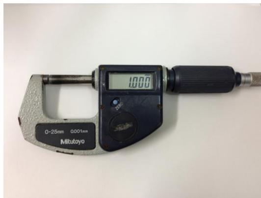
Figura 7. Micrômetro usado para verificar as espessuras (Mitutoyo®).
